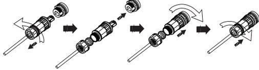
c. Entfernen Sie die wasserdichte Brücke von DC+ und DC- und stecken Sie dann das Netzkabel (L2) in DC+ und DC-.
