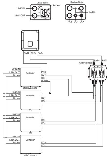
Hinweis: Halten Sie einen Abstand von 300-600 mm zwischen der Batterie und der Anschlussdose ein. Das Netzkabel (L2) muss vor dem Biegen mehr als 80 mm gerade von der Batterie DC+/- verlegt werden.
