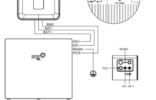
Hinweis: Leistungskabel mind. 80mm gerade verlegen, danach biegende Verlegung möglich.
